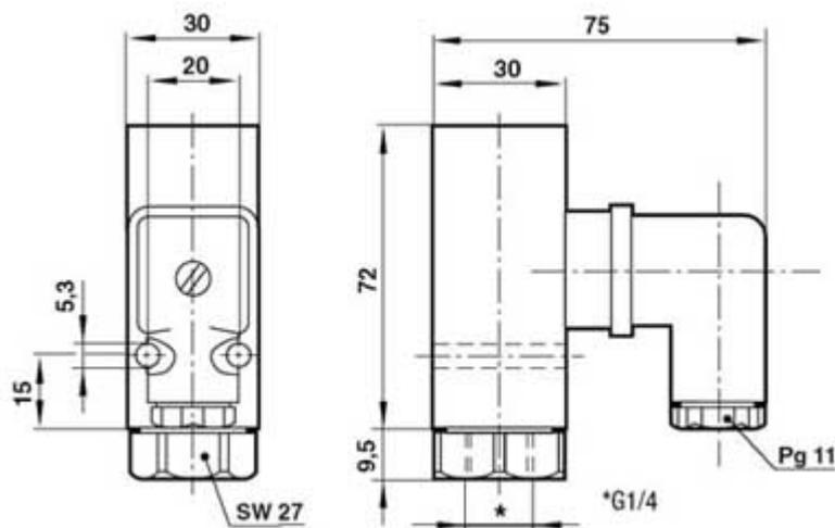
**Nota:** il pressostato è fornito con connettore elettrico.Ritorna a: <0> [Indice dei contenuti](#)
