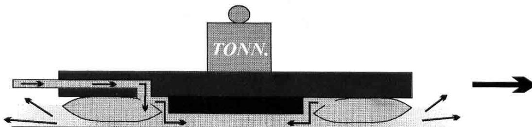
Terza fase: Quando la pressione dell' aria all' interno della camera interna é sufficiente a sollevare da terra il peso del carico, l' aria comincia a sfuggire lentamente e costantemente tra il cuscinetto torico ed il pavimento. Il carico, quindi, si trovera' a "galleggiare" su un cuscinio d' aria sottile e senza frizione, dello spessore di 0.1 - 0.2 mm.
