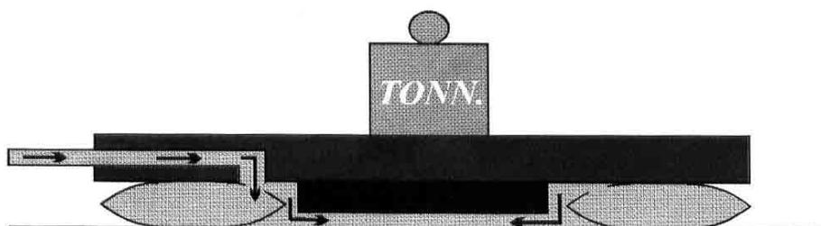
Seconda fase: Quando nell' Aero-Caster viene introdotta l'aria compressa di tipo standard (**3.5 bar**), la camera d'aria toroidale si gonfia, creando così un sigillo contro la superficie del pavimento.
